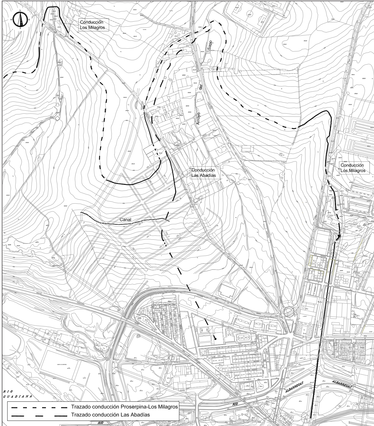
FIGURA 69 Recorrido de los acueductos por el solar.
